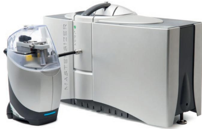
L'Aero M est un chargeur de poudre sèche d'entrée de gamme pour le Mastersizer 3000E, permettant la mesure de distributions de tailles de particules sur des échantillons de poudres sèches. Sa conception permet des mesures fiables de taille de particules pour les applications industrielles mais aussi des maintenances facilitées lors d'une utilisation habituelle.
