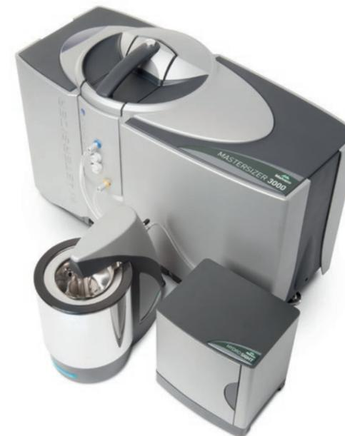
L'Hydro Sight est un système d'imagerie révolutionnaire direct et sans système optique conçu pour la gamme Mastersizer, permettant la visualisation et l'évaluation de l'état de dispersion des particules en milieu liquide.
