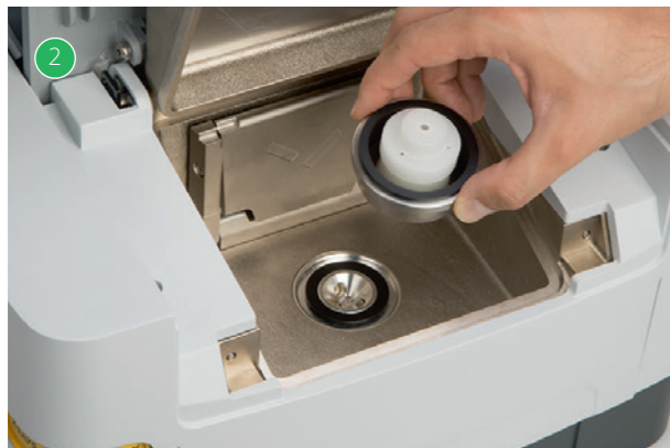
Placez votre échantillon sur la position de mesure.
