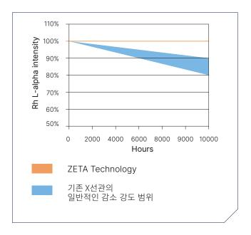
Revontium을 사용하면 신중하게 설계된 고품질 하드웨어 및 소프트웨어 구성 요소 덕분에 XRF 스펙트럼의 모든 신호를 처리할 수 있습니다. 특허를 받은 Revontium의 밀접결합 X선관은 이 기기를 위해 특별히 설계되었으며, 무증발기술 발전(ZETA)을 통해 드리프트가 매우 낮습니다. 누출을 방지하는 기능과 함께 장기적인 안정성을 제공합니다.
