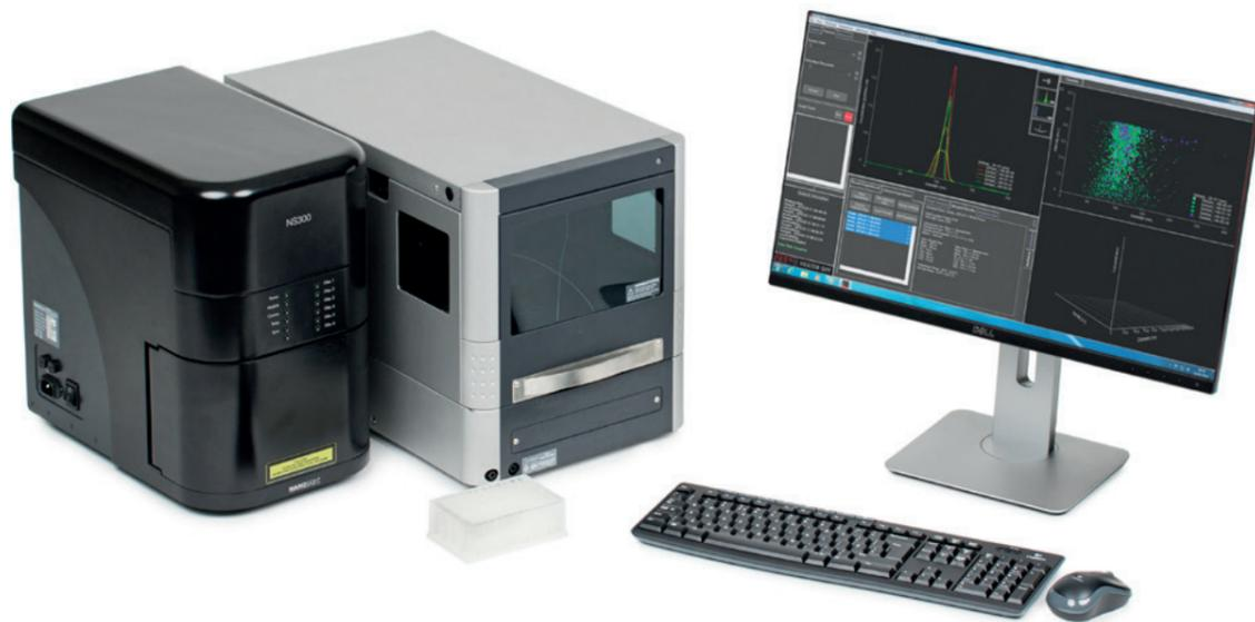
NTA 適用於許多不同樣品類型，可針對主要樣品組成及團聚物提供量化結果，如搭配螢光標記材料一起使用，則可選擇性地分析複雜樣品中特定類型的顆粒。
