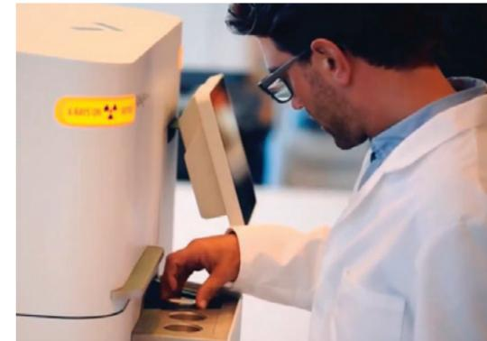
Aeris 可讓您選擇如何載入量測樣品：手動或經由自動化系統。您可將樣品安全準確載入機台，也可以在不干擾測量進行下更換樣品。
